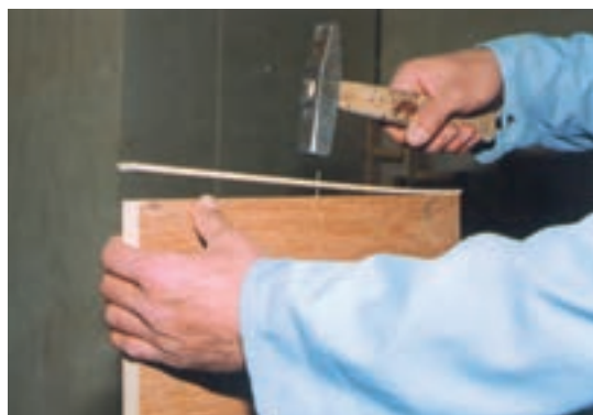
تصویر ۱۲-۶-۲ زهوارکوبی دور لبه زیرساخت
