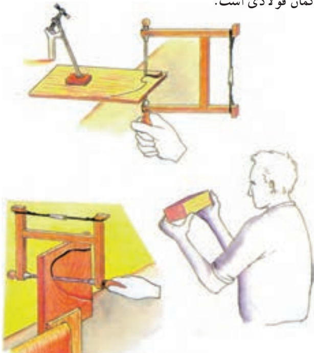
تصویر ۲-۵-۲- اره کلافی و نحوه کار کردن با آن
