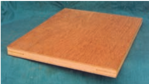
تصویر ۱۱-۶-۲- زیرساخت کلافی آماده شده بعد از پرس زوایا و لبه های زیرساخت به وسیله رنده اصلاح شده است.
