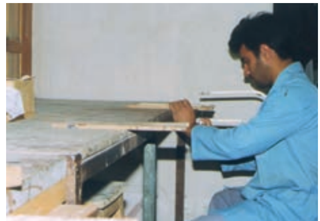
تصویر ۱-۵-۲- میز و صندلی معرقکاری- نحوه اتصال پیش کار روی لبه میز کار
