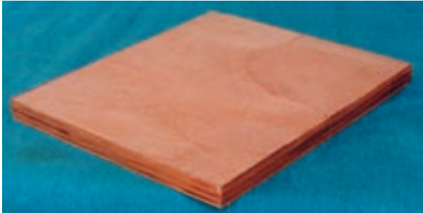
تصویر ۳-۶-۲- زیرساخت تخته لایه‌ای برای تابلوهای کوچک که عبارت است از یک هفت لایه
