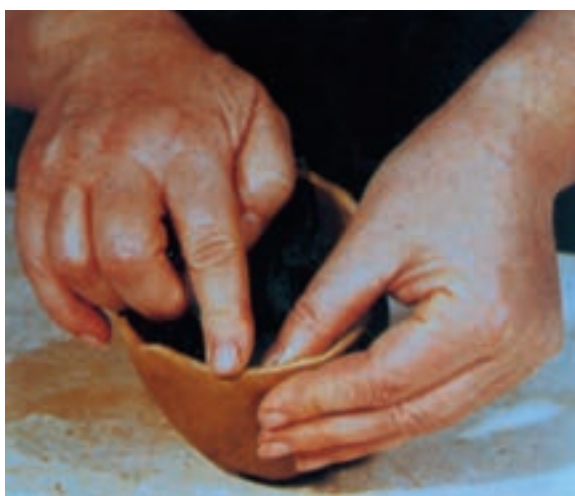
تصویر ۵-د - شکل دادن لبه‌های کاسه
