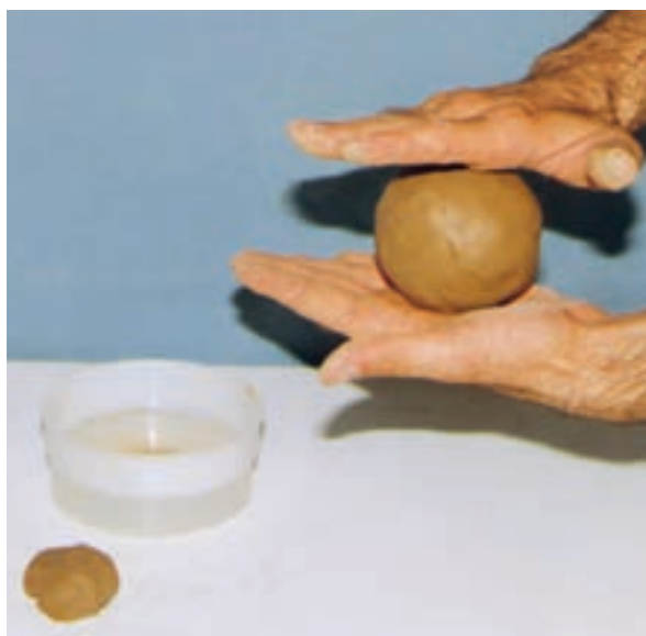
تصویر ۴- الف - ساختن گلوله گلی
