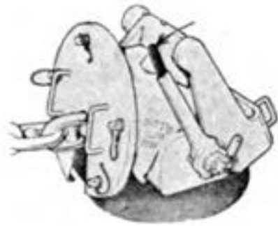
شکل ۳۳-۲- کمپرسور دهانه لوله عبور زنجیر از چاه
