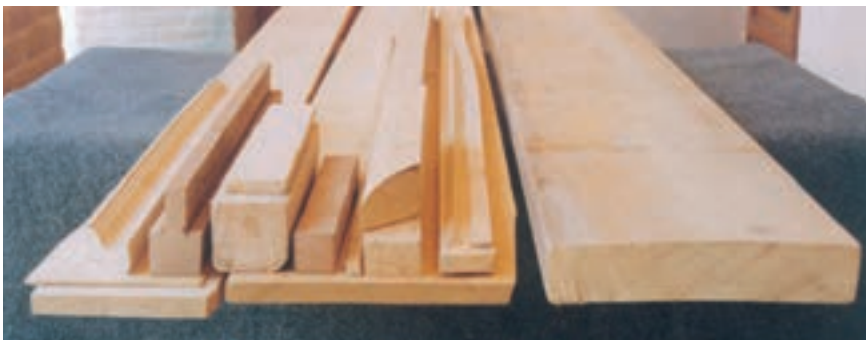
تصویر ۲۱-۱-۱- یک تخته و نمونه‌هایی از پروفیل‌های آن
