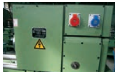
شکل ۳-۳۱ پریز سه‌فاز روی دستگاه تراش.
