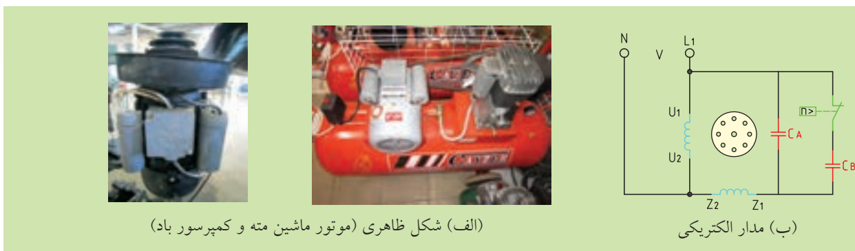
شکل ۴-۵۵ موتور تک فاز دو خازنی
