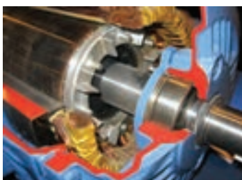
شکل ۴-۲۲ نماهای برش خورده موتور آسنکرون سه فاز.
