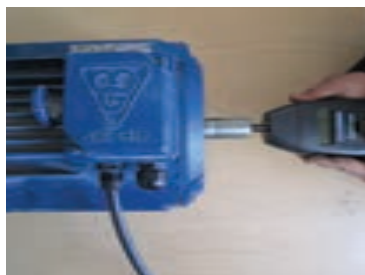
شکل ۴-۲۳ الف نحوه اندازه‌گیری مکانیکی سرعت موتور.
