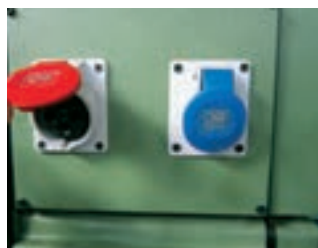
شکل ۳-۳۱ پریز سه‌فاز روی دستگاه تراش.
