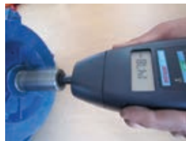
شکل ۴-۲۳ الف نحوه اندازه‌گیری مکانیکی سرعت موتور.
