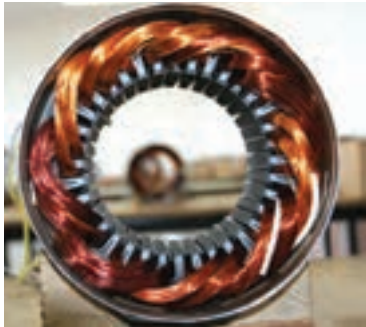
شکل ۴-۱۶ سیم پیچ های یک موتور الکتریکی .
