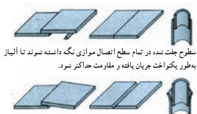
اتصالات جفت شده باعث اتلاف آلیاژ لحیم سخت شده و ممکن است مقاومت را کاهش دهد.
