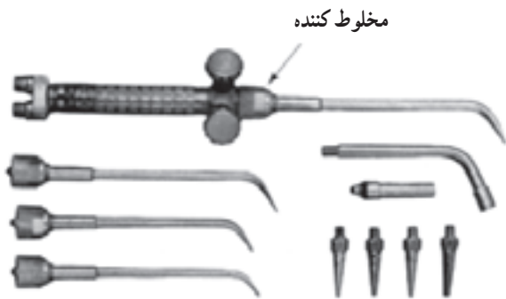
شکل ۱۵-۲- مشعل جوشکاری انژکتوری با سربک‌های یک تکه و دو تکه
