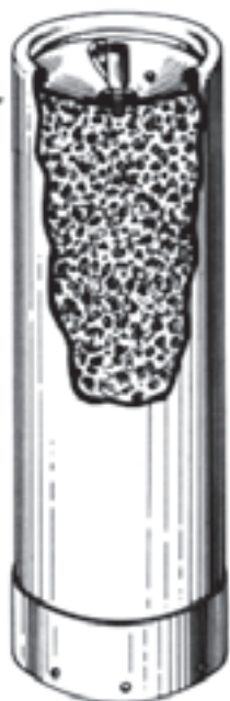
شکل ۵-۲- نمای داخل کپسول استیلن
