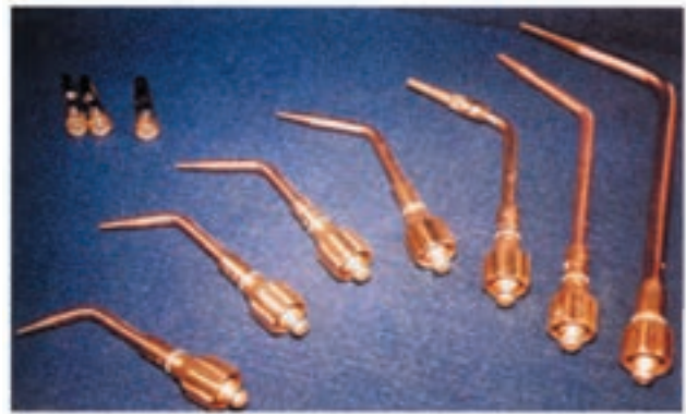
شکل ۱۵-۲- مشعل جوشکاری انژکتوری با سربک‌های یک تکه و دو تکه
