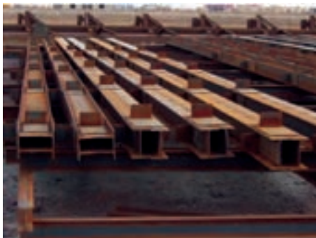
شکل ۴-۱۴- ستون با پروفیل جفت
