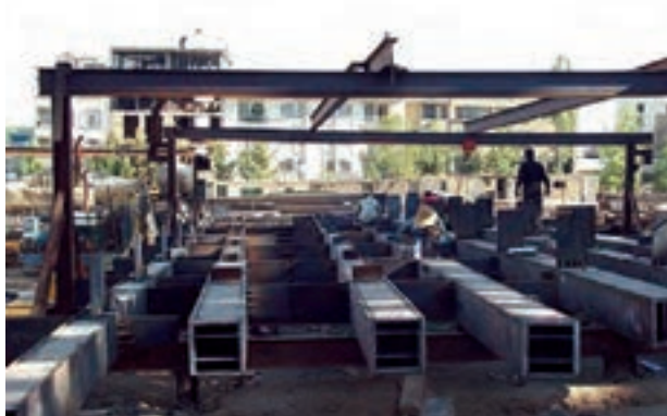
سافت ستون با مقطع جعبه‌ای در کارخانه
