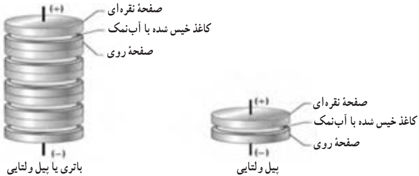
شکل ۹-۱۴ الف) پیل‌ها، و واحد تشکیل دهنده باتری‌ها هستند ب) در یک باتری باید جنس صفحه زیرین با جنس صفحه بالایی متفاوت باشد. در باتری نشان داده شده صفحه زیرین از جنس روی و آخرین صفحه بالایی از جنس نقره است.
