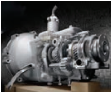
شکل ۱۵ - ترکیب پیچیده‌ای از چرخ‌دنده در جعبه‌دنده خودرو
