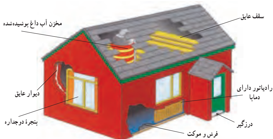
شکل ۱۲- روش‌های مختلف جلوگیری از اتلاف گرما در خانه
