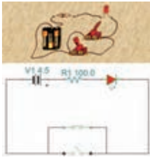
شکل ۶-۶- مدار شبیه‌سازی شده با نرم‌افزار ادیسون
