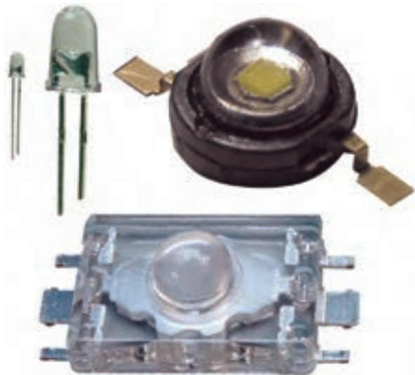
شکل ۱-۴ چند نمونه LED با نور زیاد (HB)
