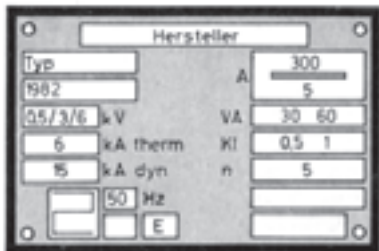
شکل ۵-۶۷- تابلوی مشخصات ترانسفورماتور جریان
