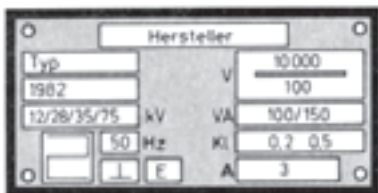
شکل ۵-۶۹- پلاک مشخصات ترانسفورماتور ولتاژ
