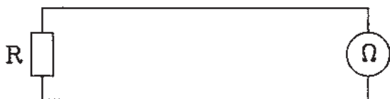
شکل ۵-۵۴- مدار اتصال اهم متر به مقاومت
