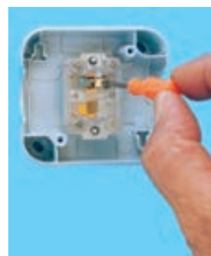
ج - برقراری اتصال پلاتین با کنتاکت غیر مشترک ۱
