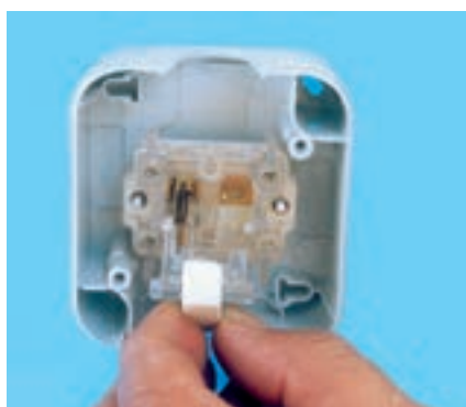
ب - شستی و فنر کلید تبدیل
