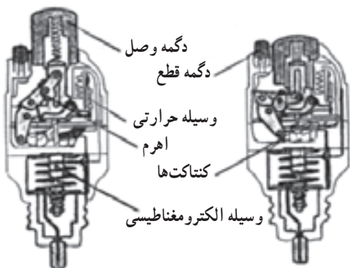
شکل ۱-۶ - ساختمان داخلی فیوز آلفا
