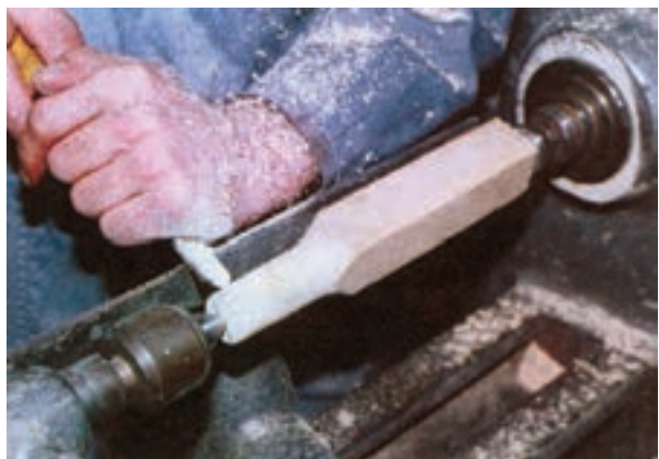
شکل ۱۴-۲۳- نحوه خراطی و استوانه کردن چوب با مغار نیم گرد گلوبی
