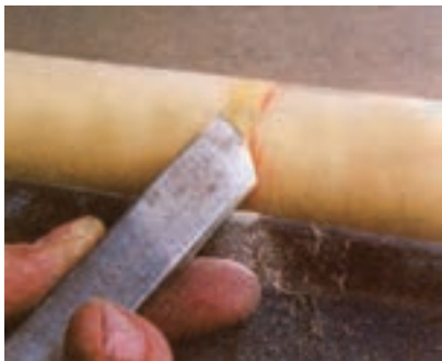
شکل ۱۴-۲۶- صاف و یکنواخت کردن سطح استوانه
