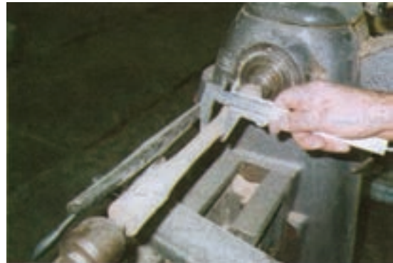
شکل ۲۷-۱۴- کنترل اندازه قطر قطعه در حال خراطی به وسیله کولیس
