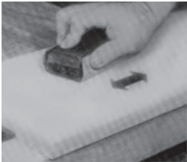
شکل ۷۰-۱۴- پرداخت کاری قطعات الاکلنگ به وسیله سنباده
