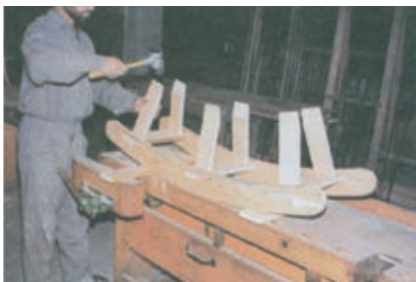
شکل ۱۴-۷۹- نحوه مونتاژ پایه‌ها و جلوگیری از نوسانات قید خمیده پایه
