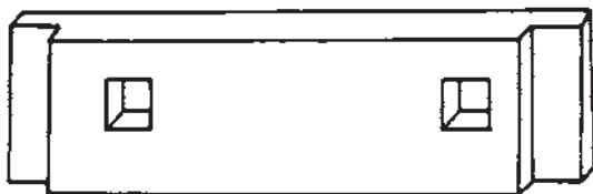
شکل ۶۳-۱۴- قید افقی اتصال پایه قطعه شماره ۱۰
