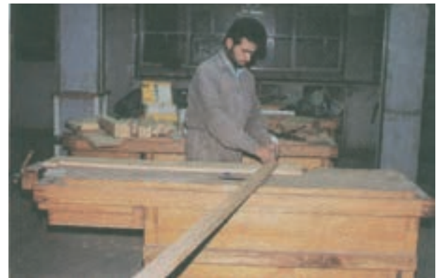
شکل ۱۷-۱۴- هنرجو در حال ترسیم قوس با شعاع زیاد قید خمیده پایه الاکلنگ می‌باشد.
