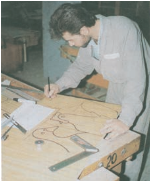
شکل ۱۵-۱۴- هنرجو در حال طراحی قطعات الکلنگ روی M.D.F روکش شده
