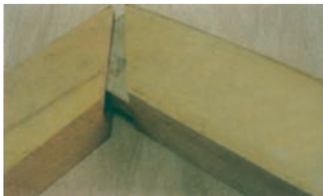
شکل ۸۹-۱۴- اتصال کام و زبانه
