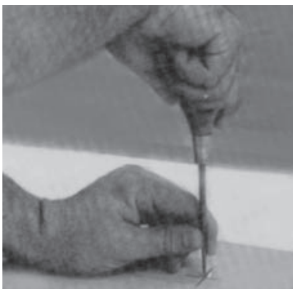
شکل ۵۱-۱۴- محل سوراخ‌ها را با درفش علامت‌گذاری کنید.
