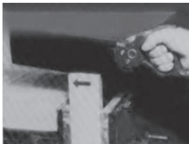
شکل ۱۴-۴۲- برش زبانه قطعه شماره ۱۰ با اره ظریف بر پشتهدار
