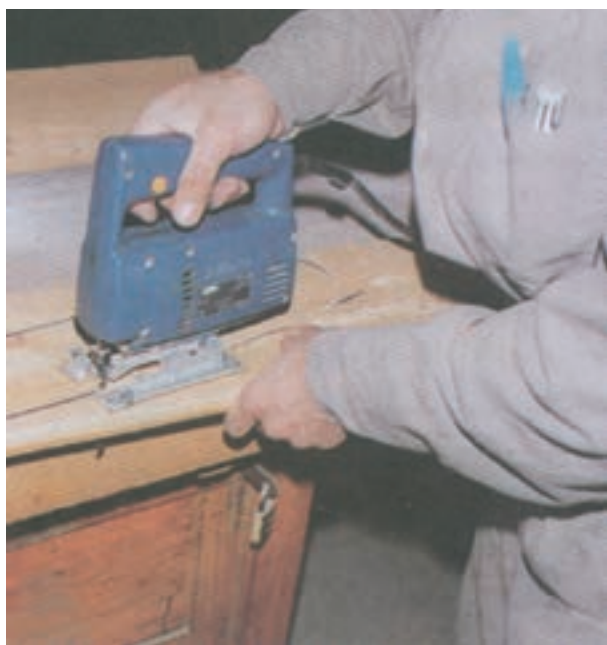
شکل ۳۳-۱۴- برش کاری قوس خارجی قطعه شماره ۱۱
