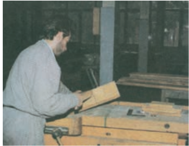
شکل ۱۴-۳۶- استفاده از گیره میزکار در موقع برش قطعه شماره ۸
