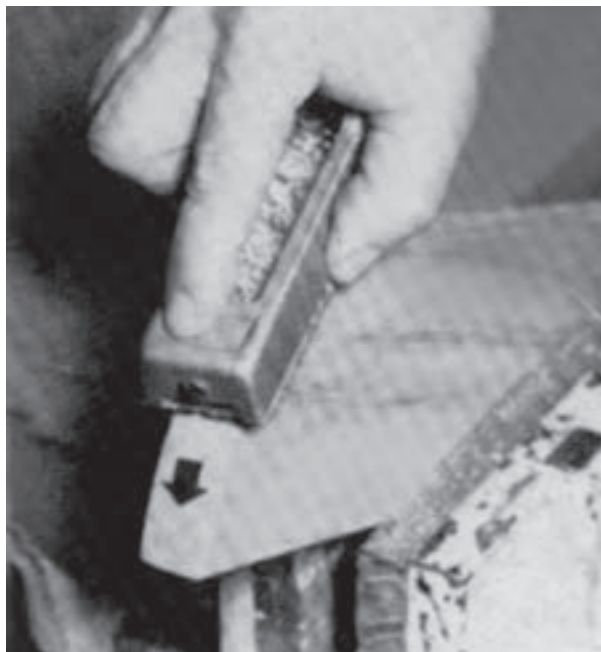
شکل ۵۸-۱۴- استفاده از چوسا رنده‌ای در فرم دادن قطعه شماره ۷
