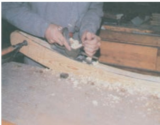
شکل ۴۷-۱۴- دو قطعه مشابه قید خمیده پایه بهم بسته شده و به وسیله رنده قوس رنده تسطیح می‌گردد.
