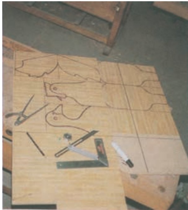
شکل ۱۸-۱۴- ترسیم قطعات الاکلنگ روی صفحه نازک برای تهیه شابلون
