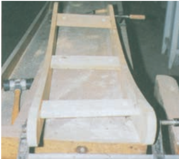
شکل ۷۲-۱۴- مونتاز کردن مقر خمیده پایه با چکش لاستیکی و پیچ دستی
