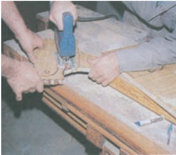
شکل ۲۸-۱۴- استفاده از نیروی کمکی و فرو رفتگی سطح میزکار در موقع برش
