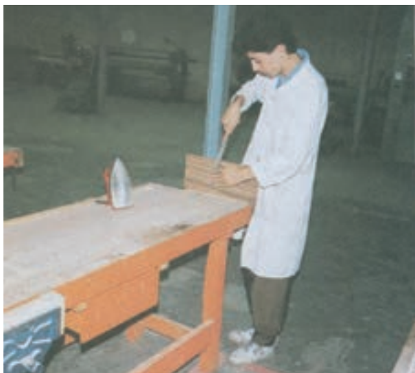
شکل ۵۰-۱۴- بیخ زدن قسمت خارجی با سوهان یا چوبسا برای جلوگیری از کندگی
