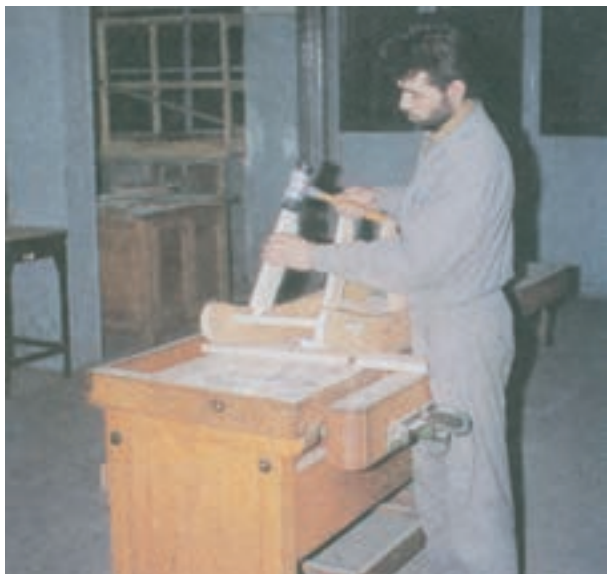
شکل ۱۴-۷۸- نصب قطعات پایه رو قید خمیده مقر پایه
