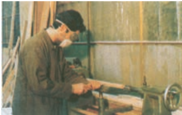
شکل ۱۳-۱۳- طرز کار با ماشین خراطی
