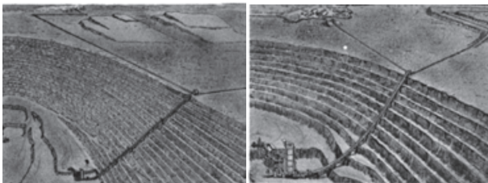
شکل ۱۱-۱۶- استفاده از نوار نقاله در معادن روباز
