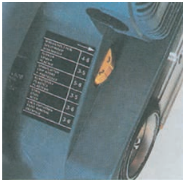
شکل ۹-۱۰- کلید تنظیم دور متناسب با نوع کار
