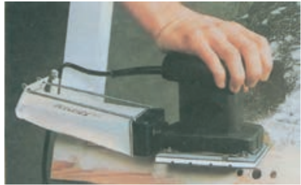
شکل ۹-۳۶- به وسیله‌ی ماشین‌های سنباده لرزشی کوچک (مشتی) می‌توانید سطوح کوچک را جهت آستری و رنگ‌کاری سنباده‌کاری کنید.
