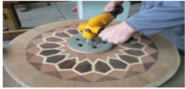
شکل ۲۵-۹- به وسیله ماشین سنباده دیسکی (بشقابی) صفحاتی روکش چسبانی شده اند. به طور ساده یا نقشه دار (با طرح های مختلف) می توانید سنباده کاری و پرداخت کنید. با تعویض دیسک سنباده آن و قرار دادن صفحه نمدی به ماشین، سطوح پولیستر شده را پرداخت کنید.
