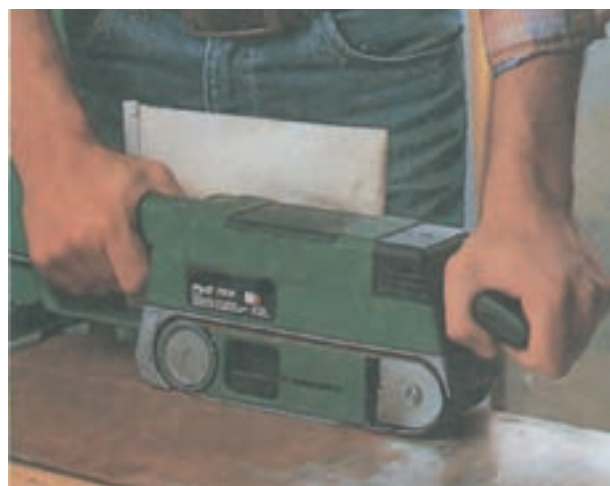
شکل ۹-۱۱- کار را محکم به میز کار ببندید.
