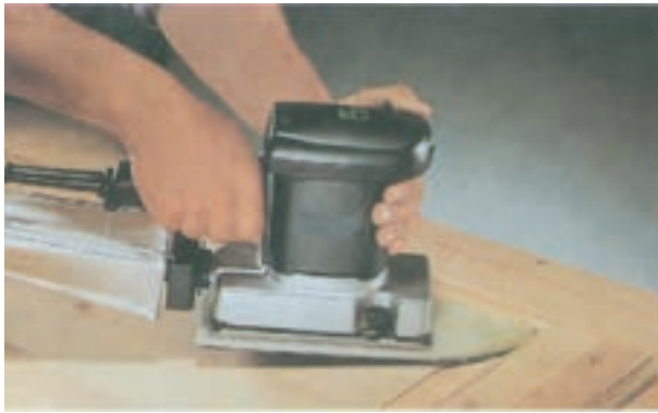
شکل ۹-۳۷- سطوح قاب‌های ساخته شده را می‌توانید به وسیله‌ی ماشین سنباده لرزشی جهت آماده‌سازی آن‌ها برای رنگ‌کاری، سنباده‌کاری کنید.
