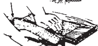
شکل ۹-۷- نحوه‌ی عمل قطع کردن سنبناده، سنبناده کاری باید در جهت الیاف چوب باشد.
