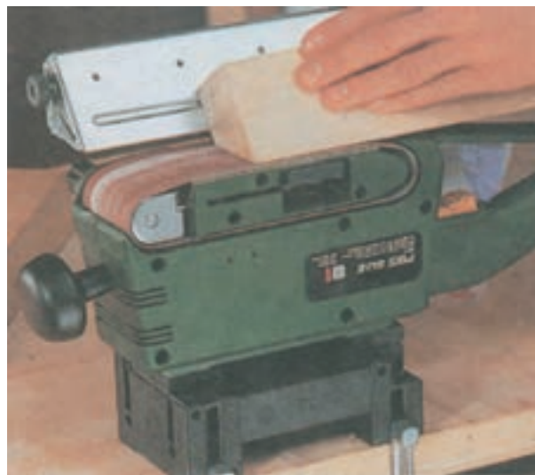
شکل ۹-۱۴- با استفاده از تکیه‌گاه قابل تنظیم می‌توان چوب‌ها را تحت هر زاویه به وسیله ماشین سنباده نواری پرداخت کنید.
