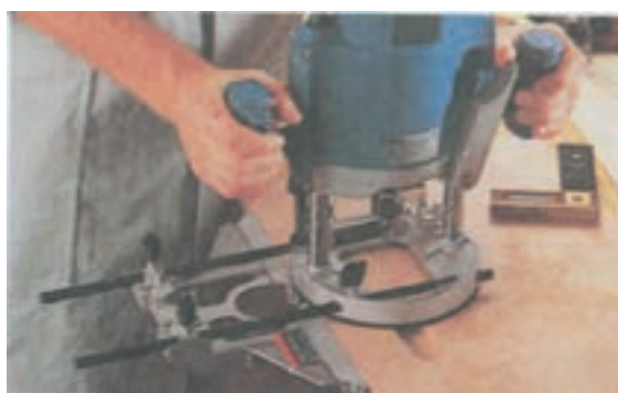
شکل ۳۶-۸- طریقه زدن شیار با تیغ فرز در طول معین. پیش برد کار ماشین باید در حد ظرفیت ماشین باشد.
