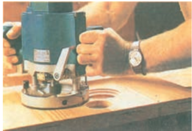
شکل ۸-۲۵- نحوه‌ی زدن دایره روی صفحات به‌وسیله‌ی ماشین فرز
