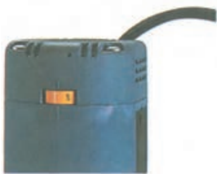
شکل ۳۱-۸- روشن و خاموش کردن و تغییرات دور به وسیله‌ی کلید مربوط انجام می‌شود.
