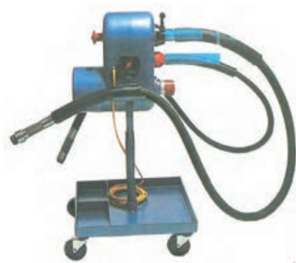
شکل ۸-۴۰- دستگاه فرز خرطومی با دور غیرمستقیم و متغیر
