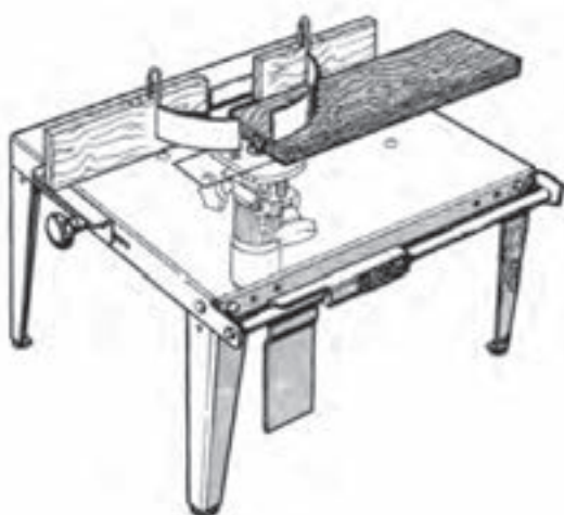
شکل ۸-۵۲- استقرار فرز زیر صفحه میز
