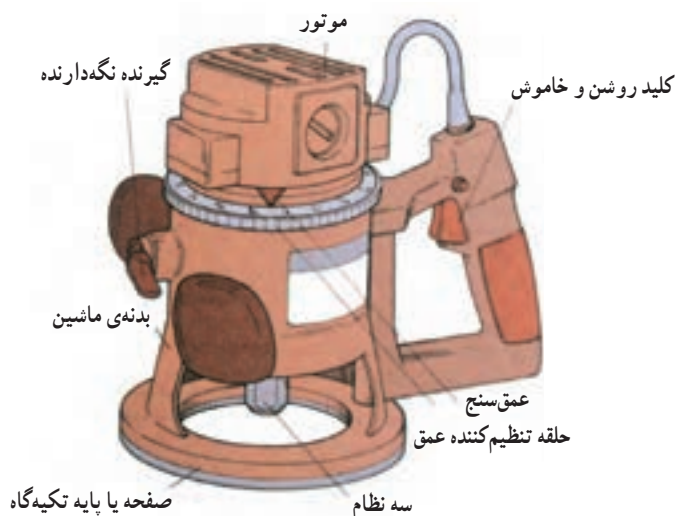
شکل ۱۱-۸- نوعی ماشین فرز که نحوه‌ی تنظیم آن به وسیله‌ی حلقه تنظیم‌کننده انجام می‌شود.
