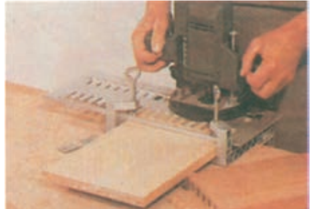
شکل ۸-۲۳- با بستن شابلن اتصال دم چلچله روی قطعات چوبی، می‌توان با به کارگیری ماشین فرز دستی اتصال مذکور را انجام داد.
