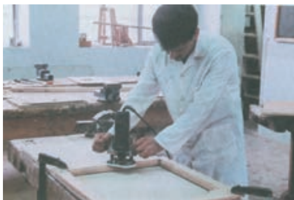
شکل ۸-۳۹- نحوه ایستادن در هنگام فرزکاری در کنار میز کار
