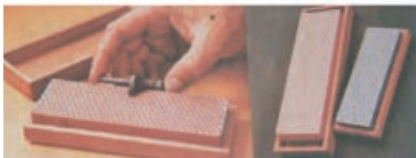
شکل ۸-۵۴- نحوه‌ی قراردادن تیغ روی سنگ نفت ساده یا فرم‌دار (بستگی به شکل تیغ دارد) به منظور تیزکردن و آماده‌به‌کارکردن تیغ فرز
