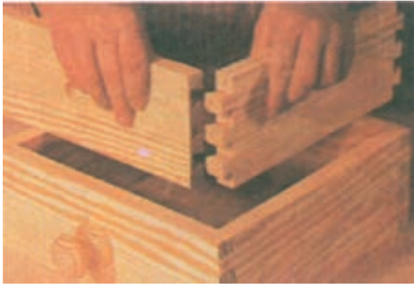
شکل ۸-۲۴- پس از ساخت اتصال دم چلچله با استفاده از شابلن و ماشین فرز، آن‌ها را مطابق شکل برای ساخت جعبه در داخل جاسازی کنید.
