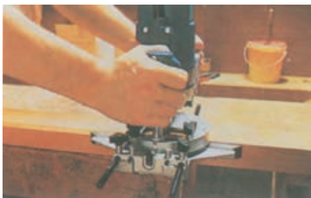
شکل ۳۰-۸- نحوه‌ی فرزکاری لبه کار با استفاده از گونیای ماشین
