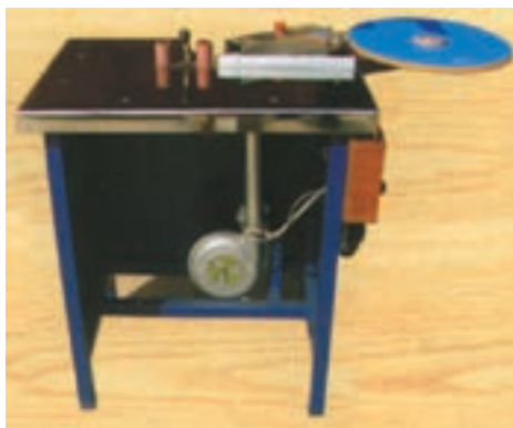
شکل ۴۱-۶- دستگاه لبه‌چسبان ساده برای نوارهای اطوئی یک طرف چسب‌دار
