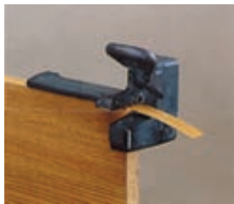
شکل ۲۵-۶- گیوتین برای قیچی کردن لبه اضافی
