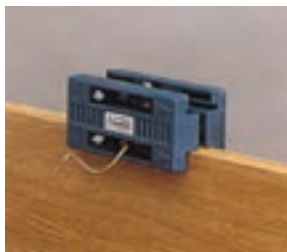
شکل ۲۴-۶- رنده دوطرفه لبه‌های اضافی نوار
