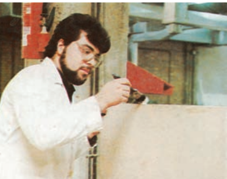
شکل ۶-۶ چسب زدن ضخامت صفحه تخته خرده چوب
