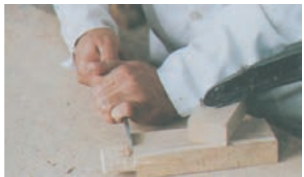
شکل ۱۴-۶ طریقه‌ی تسطیح انتهای زبانه
