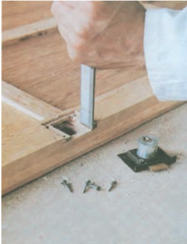
شکل ۱۵-۶ استفاده مغار برای در آوردن جای قفل
