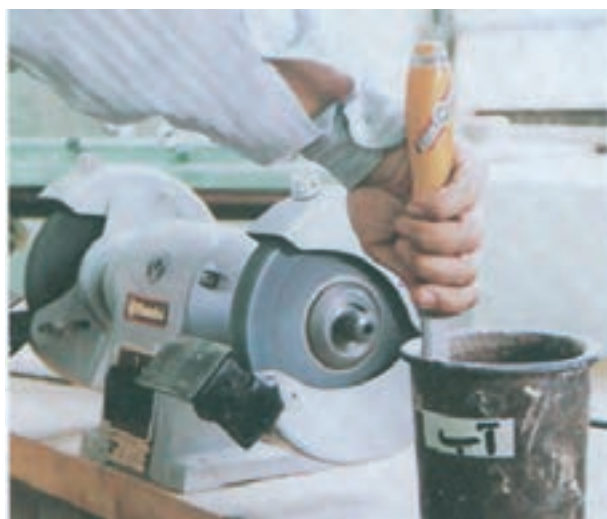
شکل ۳۳-۶- لبه تیغه را به‌طور مرتب با آب خنک کنید تا نسوزد
