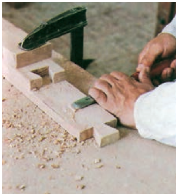
شکل ۶-۵ صاف کردن سطح اتصال با مغار
