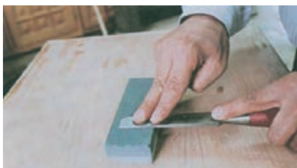
شکل ۶-۳۶- طریقه برطرف کردن پلیسه
