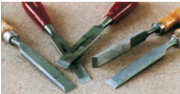
شکل ۶-۱- مغارهای ساده و بیخ‌دار
