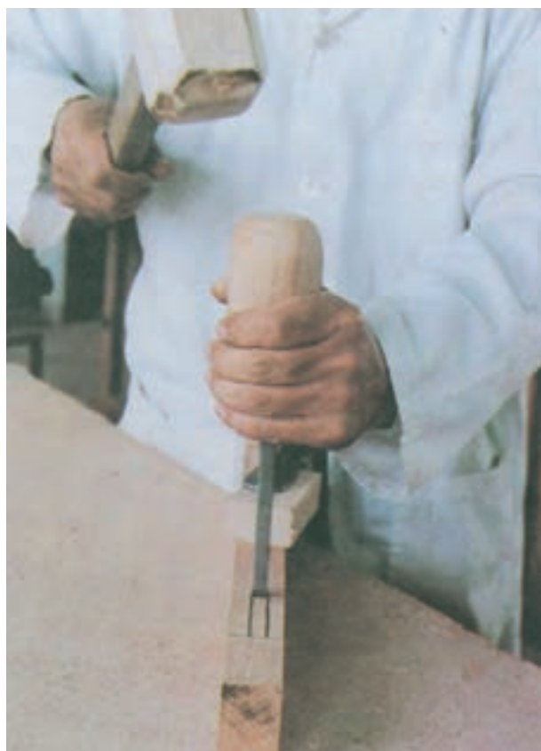
شکل ۶-۱۸- طریقه‌ی کاربرد اسکنه
