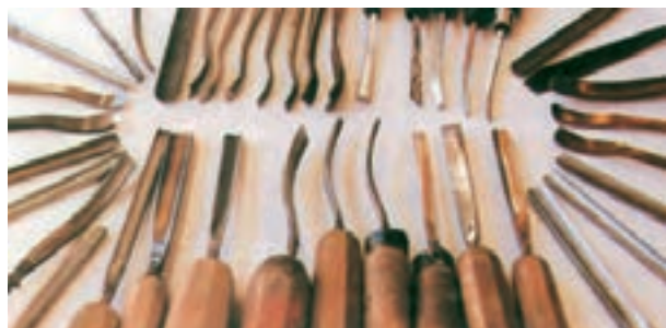
شکل ۶-۲۳- مغارهای منبت کاری
