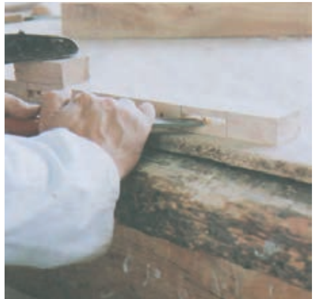
شکل ۱۳-۶ نحوه‌ی خالی کردن گُم با مغار
