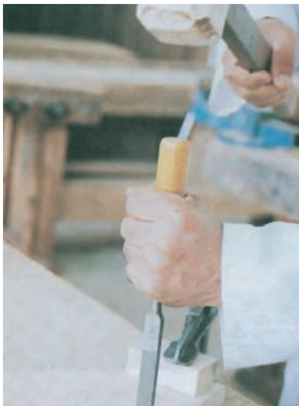
شکل ۱۰-۶- در موقع ضربه زدن از چکش چوبی استفاده شود.
