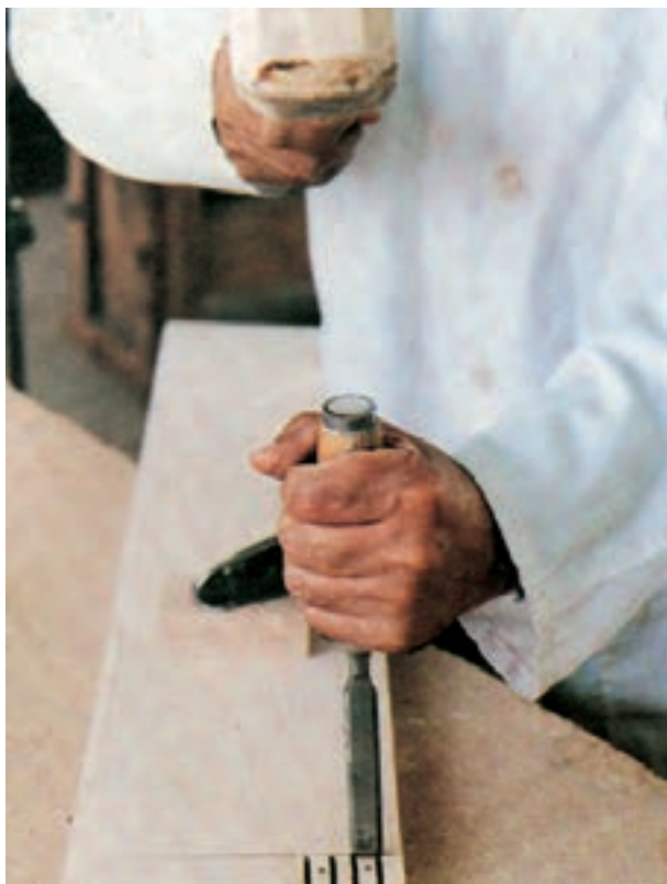
شکل ۶-۸- نحوه‌ی ضربه زدن به سر دسته‌ی مغار
