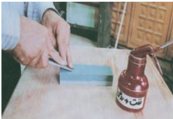
شکل ۶-۳۵- طریقه کشیدن تیغ مغار روی سنگ نفت
