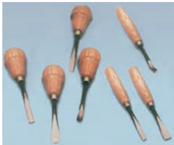
شکل ۶-۲۵- مغارهای تخت و نیم‌باز
