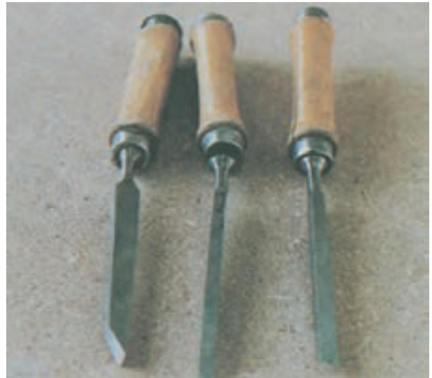
شکل ۱۲-۶ مغار در دسته کج قرار گرفته
