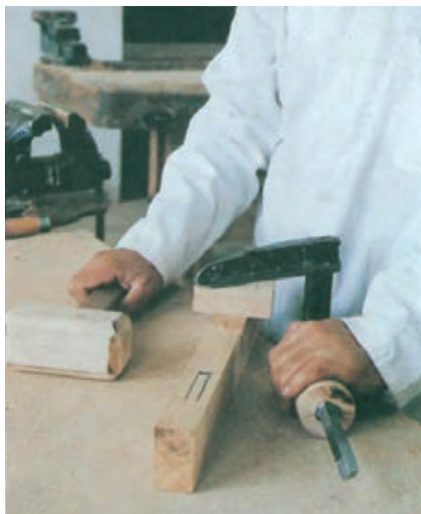
شکل ۲۱-۶- نحوه‌ی استقرار قطعه کار روی میزکار
