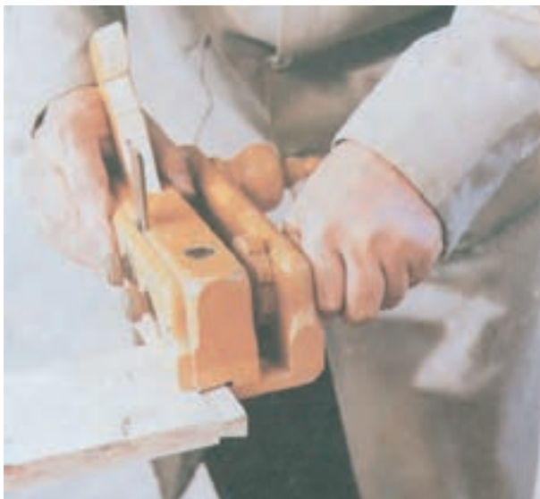
شکل ۵-۴۲- طریقه رنده کردن زبانه طرح فرنگ یا گرات
