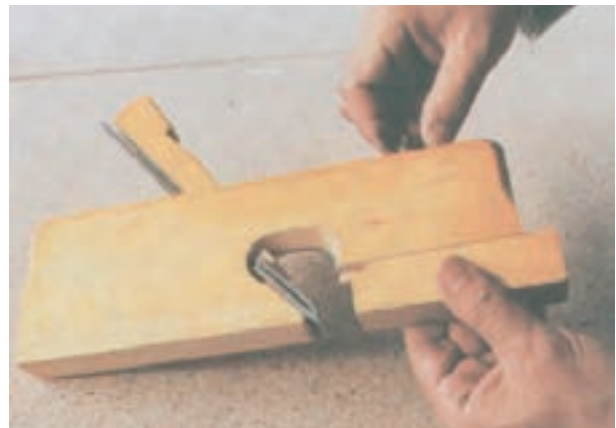
شکل ۵-۴۰- نحوه‌ی تنظیم دهانه پوشال
