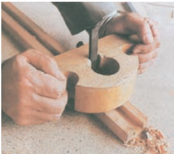
شکل ۴۹-۵- نحوه‌ی ایجاد کنشکاف طرح فرنگ با رنده چوبی مخصوص
