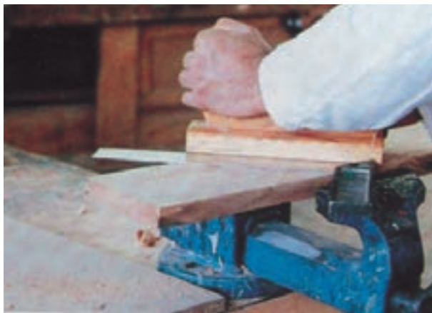
شکل ۵-۳۲- نحوه کاربرد رنده خشی
