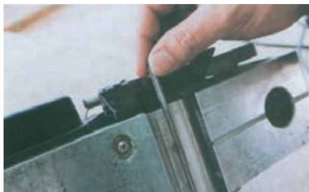
شکل ۵-۸۲- نحوه‌ی استقرار تیغه در تویی
