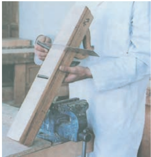
شکل ۵-۳۰- کنترل عرضی سطح رنده
