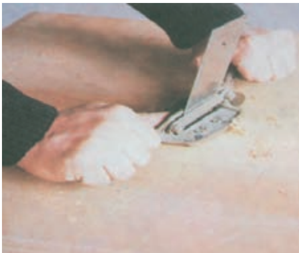
شکل ۵-۵۸- نحوه‌ی استفاده از رنده لیسه
