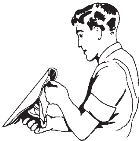
شکل ۵-۵- نحوه ی تنظیم رنده
