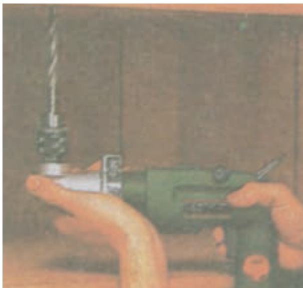
شکل ۹-۴ - دریلی که قطعه زانویی به آن سوار شده است.
