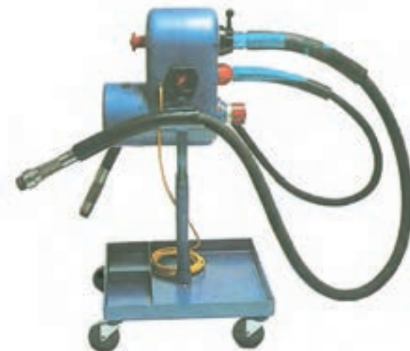
شکل ۳-۴۰- نمونه‌ای از ماشین‌های برقی سوهان و چوبسا محوری
