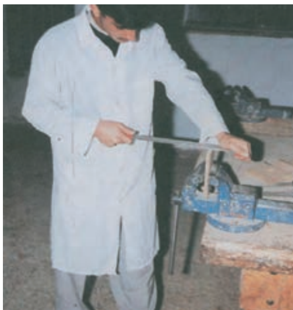
شکل ۳-۳- نحوه‌ی ایستادن جهت سوهان کاری و چوبساکاری
