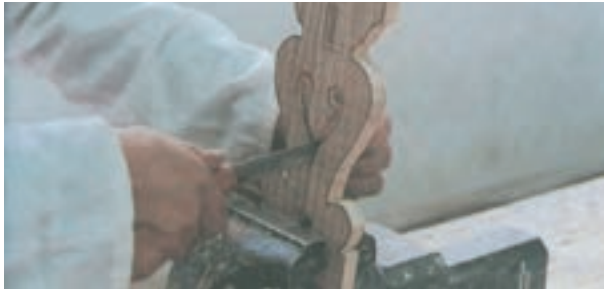
شکل ۳-۲۸- به کارگیری سوهان سه پهلو با مقطع لوزی در شیار گوده ای شکل باز اویدی تند
