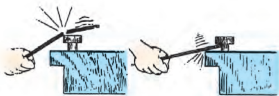
شکل ۴۸-۳- استفاده غلط از سوهان
