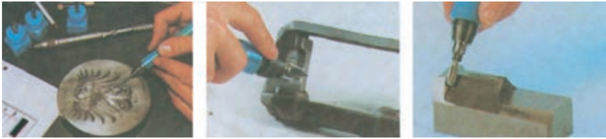
شکل ۴۶-۳- به کارگیری سه فرم سوهان محوری متناسب با محل سوهان کاری
