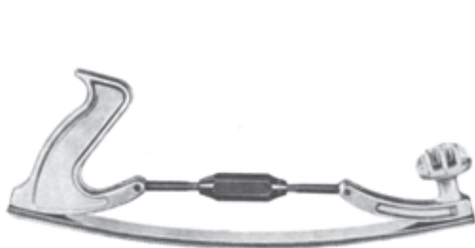
شکل ۳-۳۷- یک نوع سوهان رنده‌ای و مورد استفاده آن و آج‌های مختلف آن
