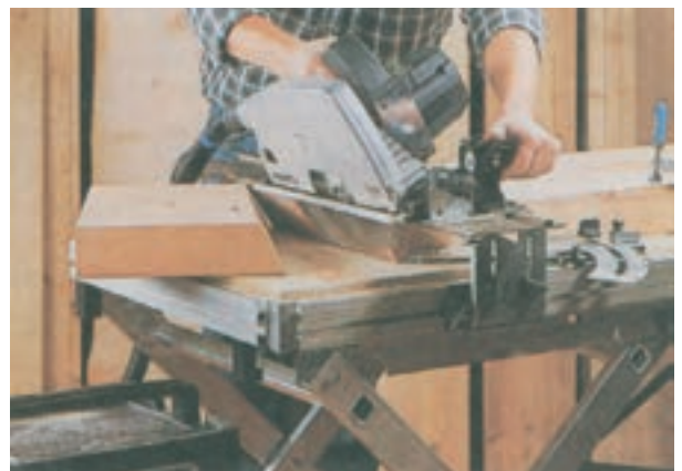
شکل ۲-۳۲- برش تحت زاویه به وسیله‌ی اره‌ی مجموعه‌ای همراه با مکند
