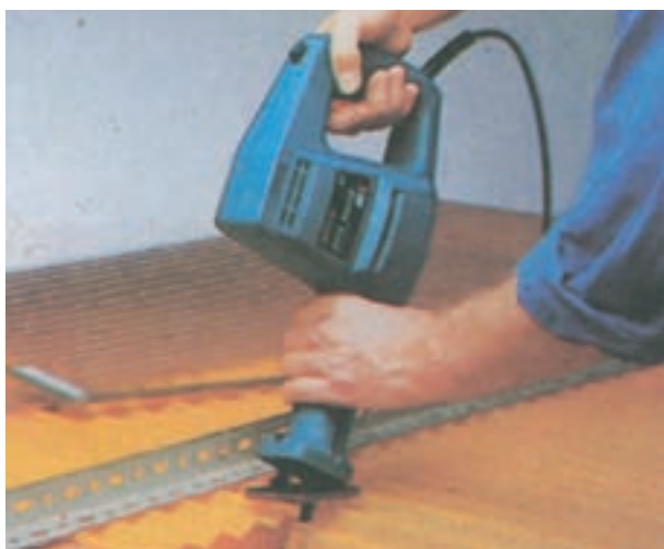
شکل ۲-۵۸- بریدن پلاستیک (مواد پلاستیکی) به وسیله‌ی اره‌ی چکشی افقی (همه‌کاره)
