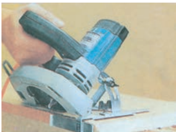
شکل ۲-۲۹- برش تحت زاویه به وسیله‌ی گونیای دستگاه
