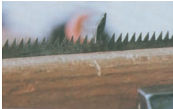
شکل ۲-۶۹- قرارگیری سوهان در بین دندان‌ها
