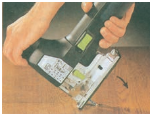
شکل ۴۰-۲- نحوه‌ی بریدن در وسط کار به وسیله‌ی کج کردن اره
