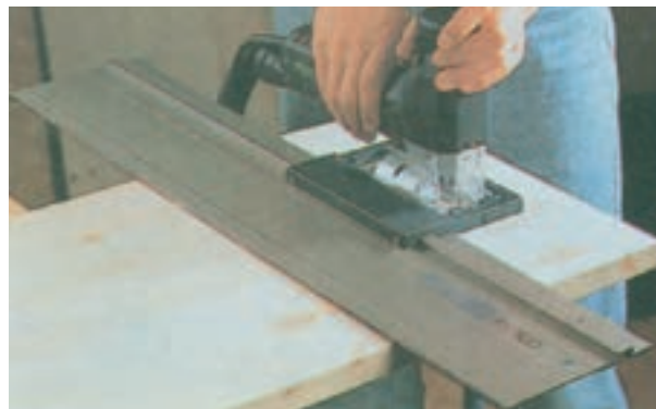
شکل ۲-۴۱- نحوه‌ی برش مستقیم اره چکشی به وسیله صفحه راهنما
