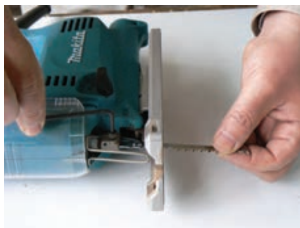
شکل ۲-۴۶- نحوه‌ی کار با آچار آلن و آزادسازی تیغه در اره چکشی عمود بُر
