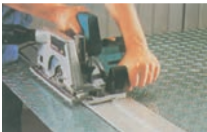
شکل ۲-۳۴- نحوه‌ی برش ورق آهن به وسیله‌ی اره‌ی گرد با کمک صفحه‌ی راهنما
