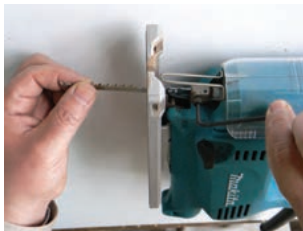
شکل ۲-۴۵- بازکردن تیغه به وسیله‌ی آچار آلن
