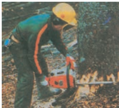
شکل ۶۱-۲- بریدن تنه‌ی درخت سرپا به وسیله‌ی اره‌ی موتوری
