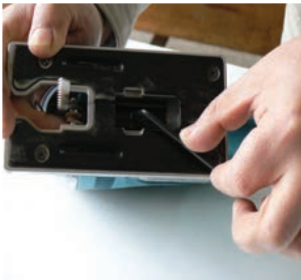
شکل ۲-۴۳- شل کردن پیچ آلن کف اره به وسیله آچار آلن
