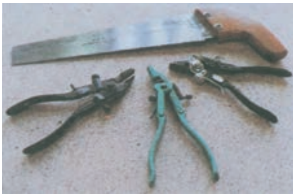
شکل ۲-۶۴- بستن چپ و راست‌کن اره
