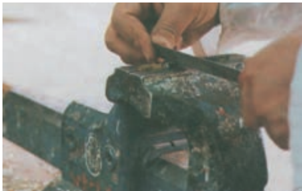
شکل ۲-۶۸- نحوه‌ی به‌دست‌گیری سوهان در تیزکردن اره‌ها
