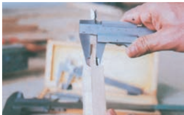
شکل ۱-۳۶- اندازه‌گیری اندازه‌ی خارجی قطعات به وسیله کولیس
