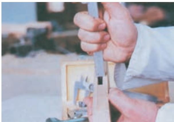
شکل ۱-۳۷- اندازه‌گیری عمق شکاف‌ها با استفاده از عمق‌سنج کولیس
