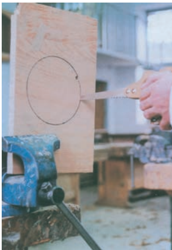
شکل ۱۲-۲- برش قطعه کار به وسیلهی اره نوکی
