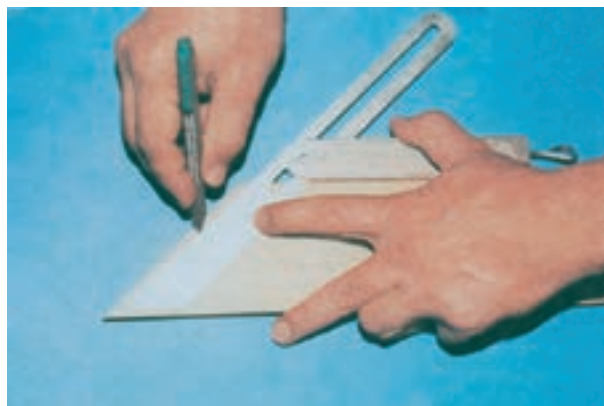
شکل ۱۸-۱- انتقال زاویه بر روی قطعه مورد نظر
