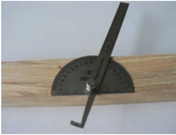
شکل ۱۵-۱ اندازه‌گیری و خط‌کشی زاویه به وسیله‌ی نقاله
