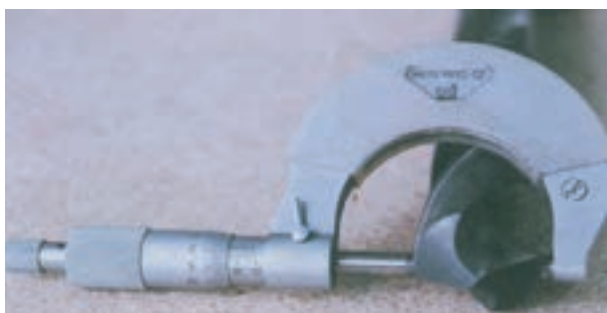
شکل ۱-۴۶- اندازه‌گیری به وسیله میکرومتر
