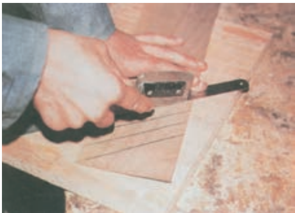
شکل ۱۹-۲- برش روکش با اره‌ی روکش‌بر
