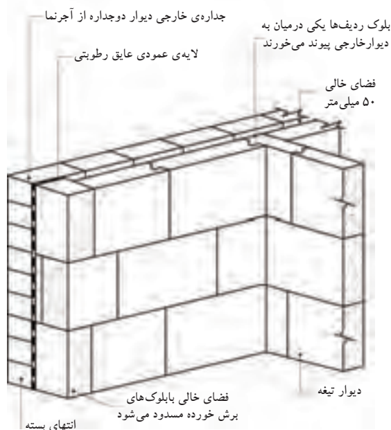
شکل ۱-۸۱ نمایش سه بُعدی از دیوار دوجداره جداره‌ی داخلی از بلوک بتنی اسفنجی و جداره‌ی خارجی آجرنما است.
