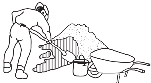
شکل ۵۵-۱ مخلوط خاک رس با آب و ساخت خمیر خشت
