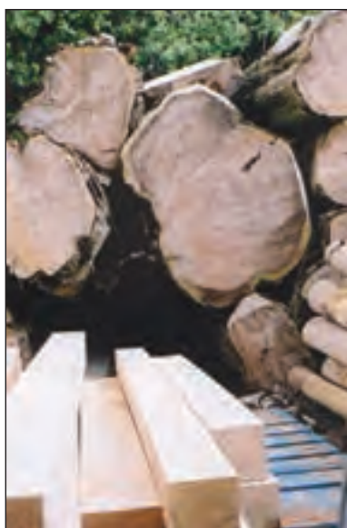
شکل ۱-۱۵۹ بالای تصویر گرده بینه - پایین تصویر الوار
