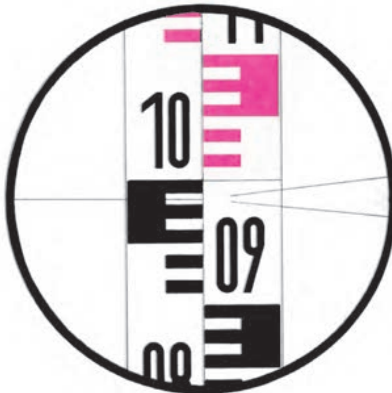
شکل ۸-۳۳- قرائت روی میر
