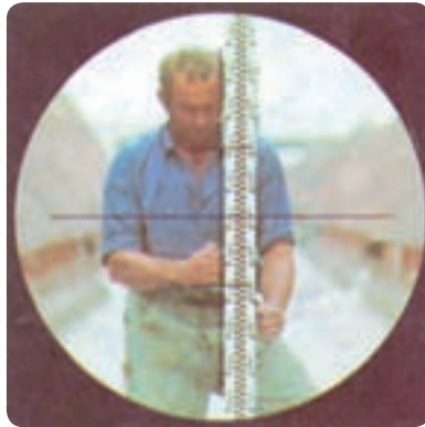
شکل ۱۴-۸- طریقه‌ی نگاه داشتن میر
