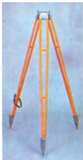
شکل ۸-۱۲- چند نمونه سه پایه تراز یاب
