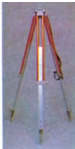
شکل ۸-۱۲- چند نمونه سه پایه تراز یاب
