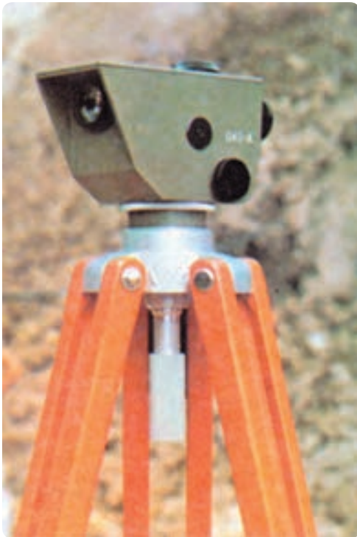
شکل ۱۰-۸- یک تراز یاب ساختمانی
