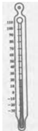
شکل ۹-۱- اندازه‌گیری درجه حرارت در یک دماسنج جیوه‌ای
