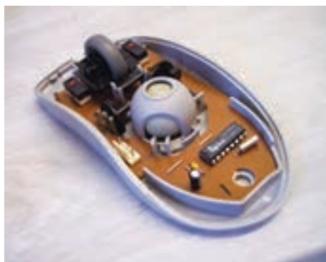
شکل ۲۶-۶ درون ماوس مکانیکی - نوری
