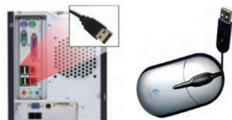
شکل ۲۴-۶ ماوس و درگاه ارتباط آن با رایانه
