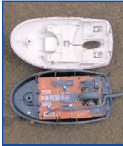
شکل ۲۷-۶ نمایشی از درون ماوس نوری
