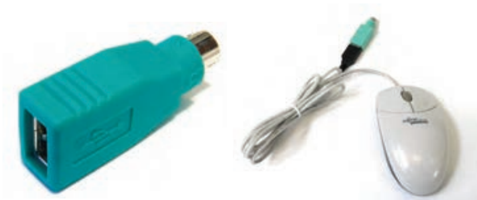
شکل ۲۸-۶ تبدیل USB به رابط PS/2 برای ماوس
