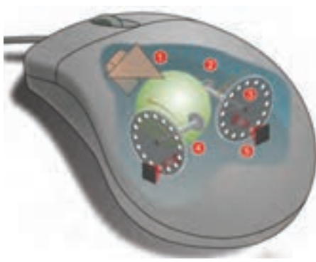
شکل ۲۶-۶ درون ماوس مکانیکی - نوری
