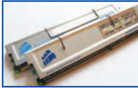
شکل ۴-۱۶ ماژول حافظه DDR SDRAM با ظرفیت ۵۱۲ مگابایت و فرکانس ساعت ۴۰۰ مگاهرتز
