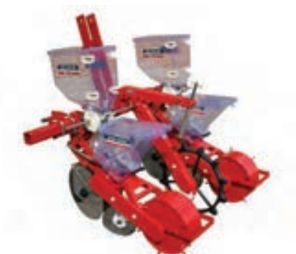
شکل ۹-۴- بذرکار دو ردیفه تراکتوری مجهز به کودکار
