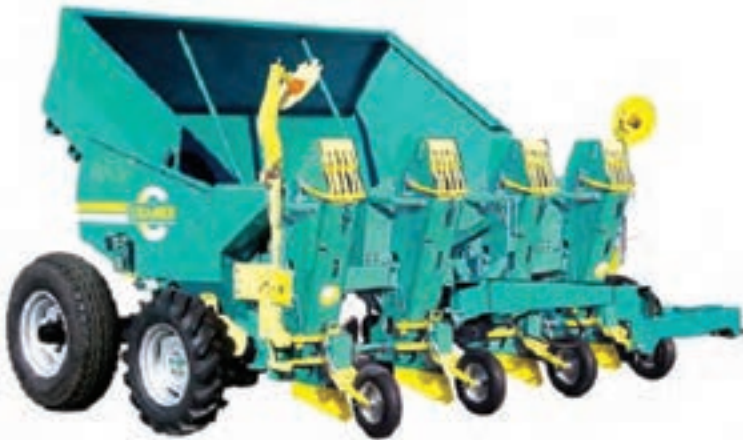
شکل ۱۶-۲- یک نوع ماشین سیب‌زمینی کار خودکار با سیستم جبران‌کننده
