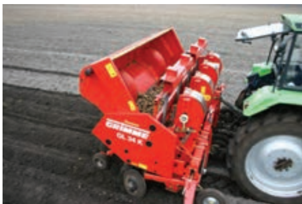
شکل ۱۷-۲- طرز کار یک نوع سیبزمینی کار خودکار
