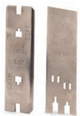
شکل ۲۷-۲- راهنمای تنظیم محدودکننده عمق
