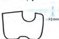
محدودکننده عمق صحیح ۰/۱۹ تا ۰/۲۵ میلی‌متر
