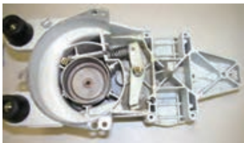
ب — پوسته کلاچ و جعبه دنده
