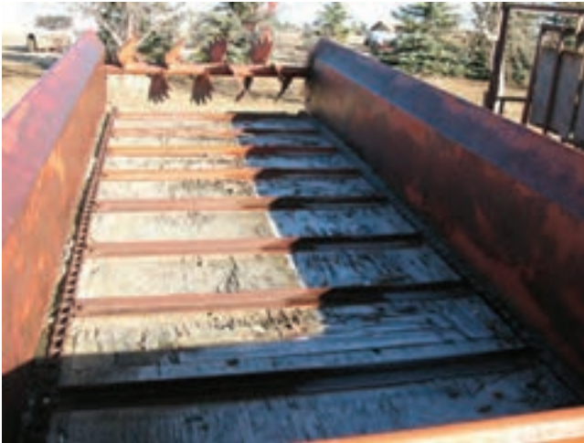
شکل ۳۹-۱- سیستم زنجیر نقاله در کف کودپاش کود دامی جامد
