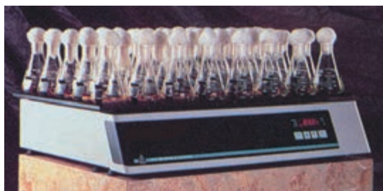
شکل ۱-۶- تکان‌دهنده مخصوص ارلن
