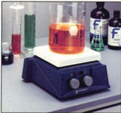
شکل ۷-۱- دو نوع همزن مغناطیسی
