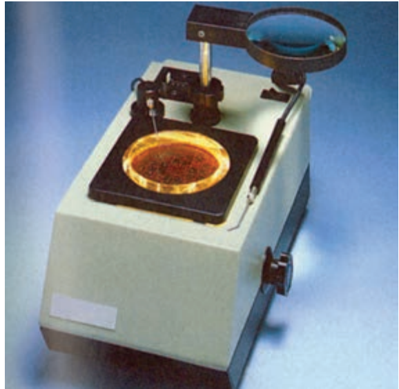
شکل ۱-۳- دو نوع پرگنه شمار
