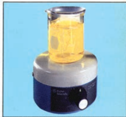
شکل ۷-۱- دو نوع همزن مغناطیسی
