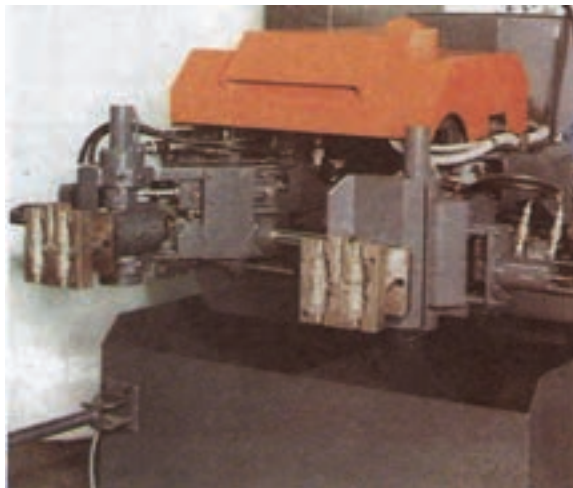
شکل ۳-۲۴— ماشین ریخته‌گری ریزه تمام اتوماتیک
