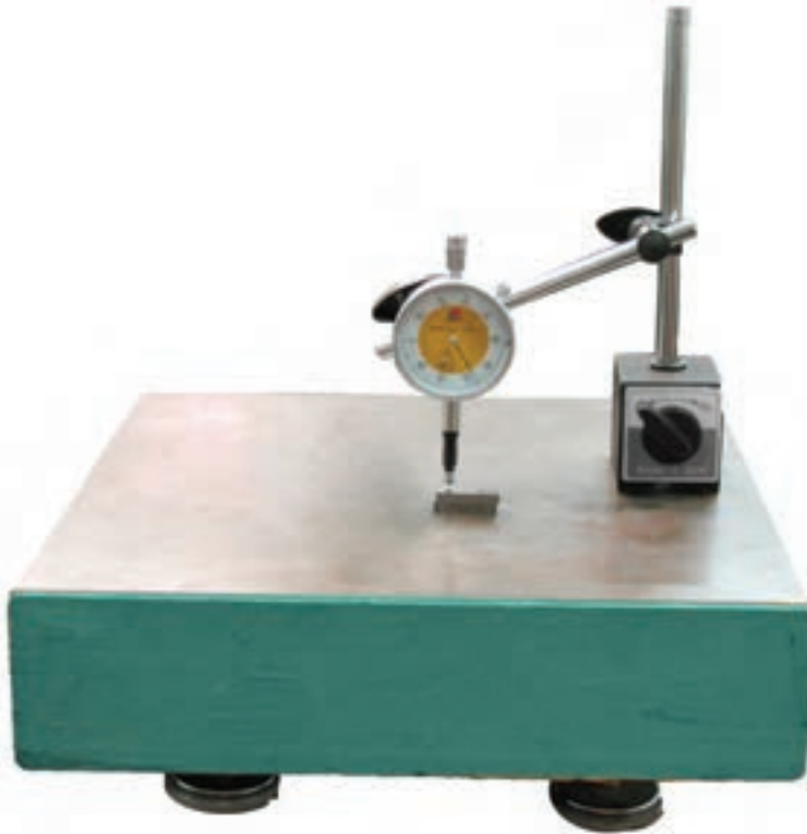
شکل ۲۱-۶- آماده‌سازی ساعت برای عملیات کنترل
