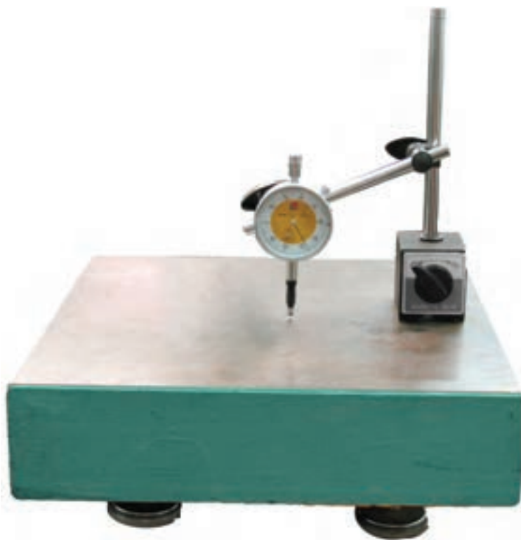
شکل ۲۰-۶- آماده‌سازی ساعت برای عملیات اندازه‌گیری
