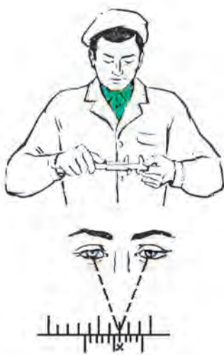
شکل ۱۹-۱ خطای دید در اندازه‌گیری
