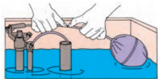
شکل ۴۲-۱۰- تنظیم نمودن یک نوع شیر شناور
