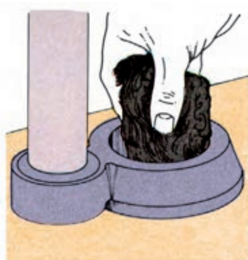
شکل ۴۴-۱۰- رسوب زدایی نشیمنگاه زیراب
