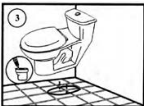
شکل ۴-۱-ب- آب‌بندی بوگیر و استقرار توالت فرنگی
