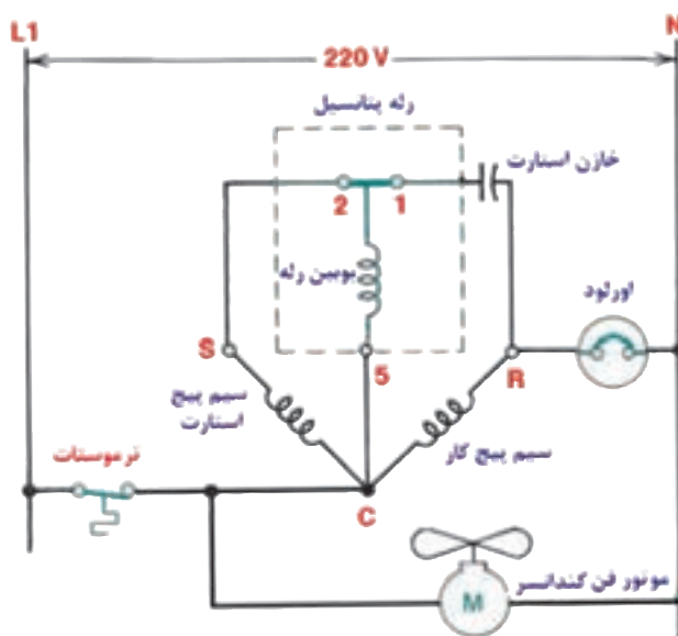
شکل ۸-۱- مدار الکتریکی آب سردکن
