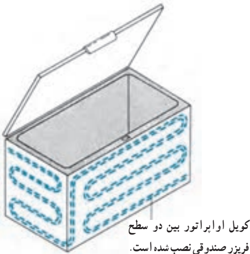
شکل ۶-۶ اوپراتور صفحه‌ای در دستگاه فریزر صندوقی
