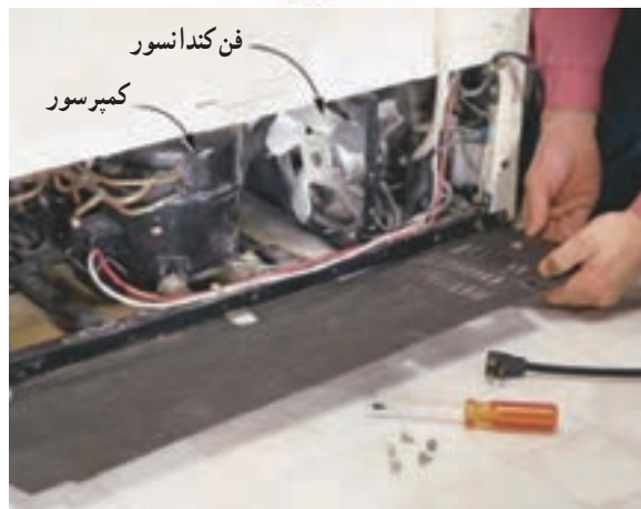
شکل ۶-۳- اجزای یخچال خانگی به صورت شماتیک و حقیقی
