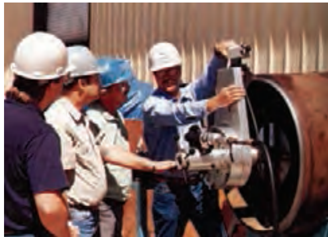
شکل ۷-۴۵- دستگاه برش هیدرولیکی که نوع پخ و زاویه آن را دقیقاً برش می‌زند.
