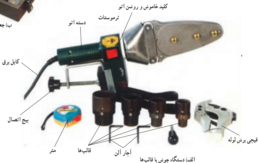
شکل ۲-۵ اتوی جوش فیوژن و متعلقات آن
