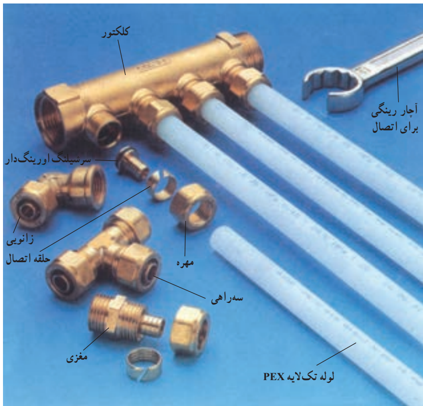
شکل ۳-۸- فیتینگ‌های لوله‌های تک‌لایه PEX که به وسیله مهره، حلقه اتصال و سرشیلنگ اورینگ‌دار به لوله متصل می‌شود.
