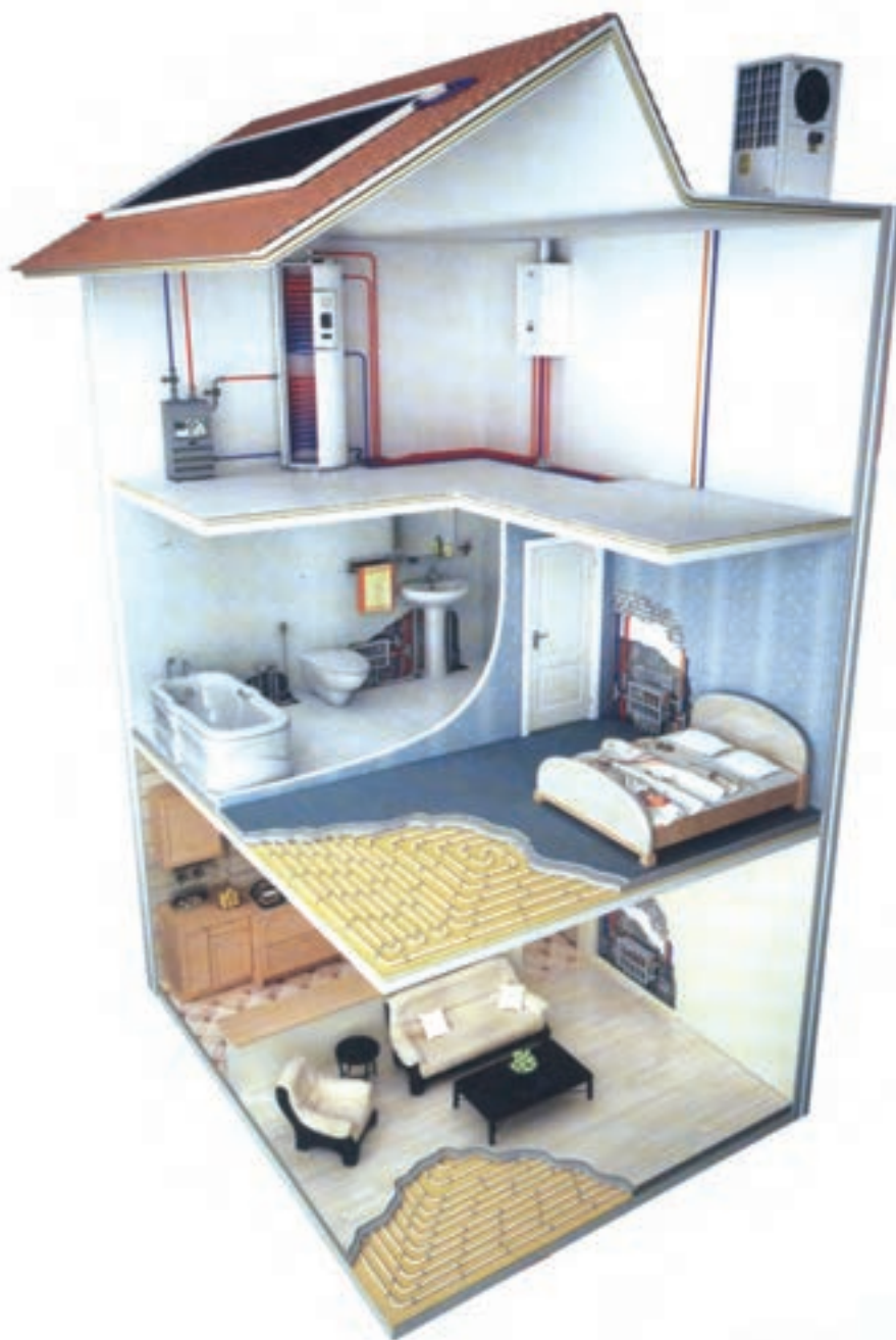
شکل ۲-۳- کاربرد لوله تک‌لایه PEX
