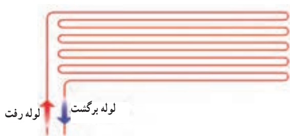
شکل ۲۰-۴- آرایش مارپیچی (کویلی) کف گرمایی
