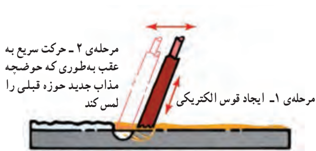
شکل ۳-۴- تشکیل مهره جوش
